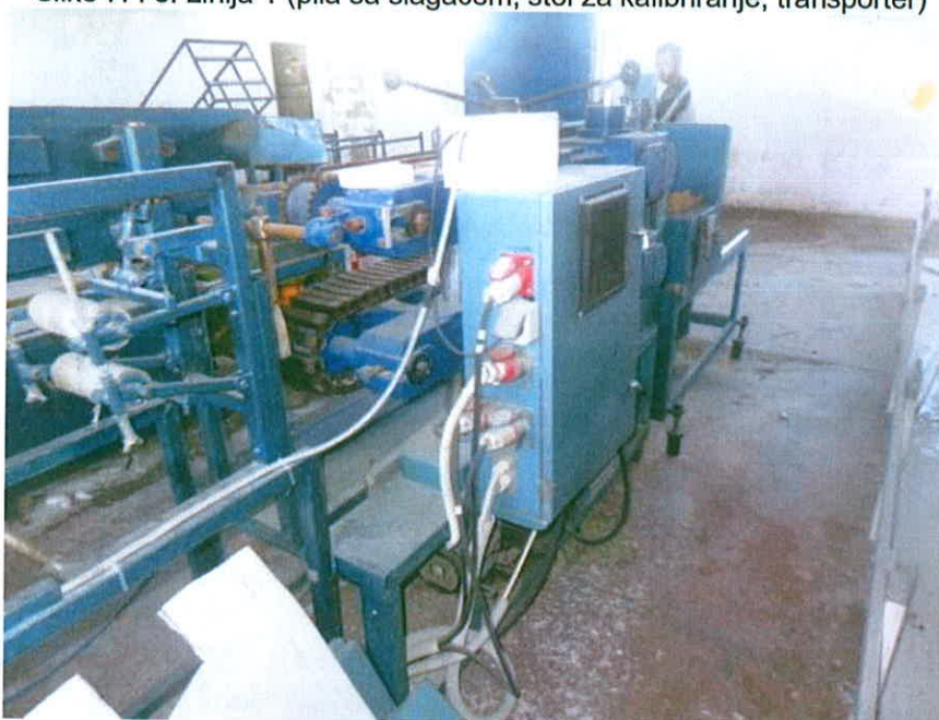
Slike 7. i 8. Linija 1 (pila sa slagačem, stol za kalibriranje, transporter)
