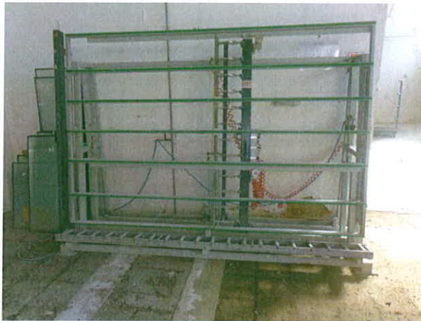
Slike 61 i 62 Presa za ostakljivanje i Stroj za okivanje prila PVC prozora
