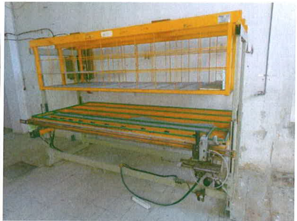
Slike 61 i 62 Presa za ostakljivanje i Stroj za okivanje prila PVC prozora
