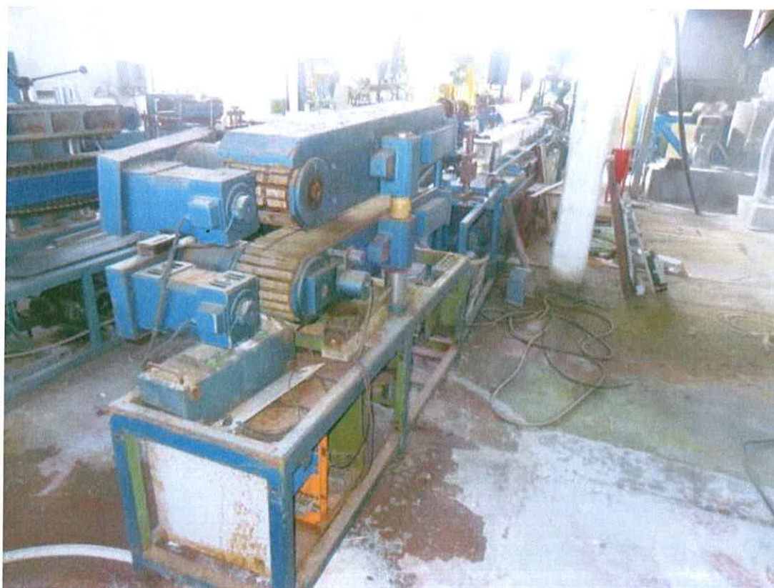
Slike 13 i 14. Linija 2 (pila sa slagačem, stol za kalibriranje, transporter)
